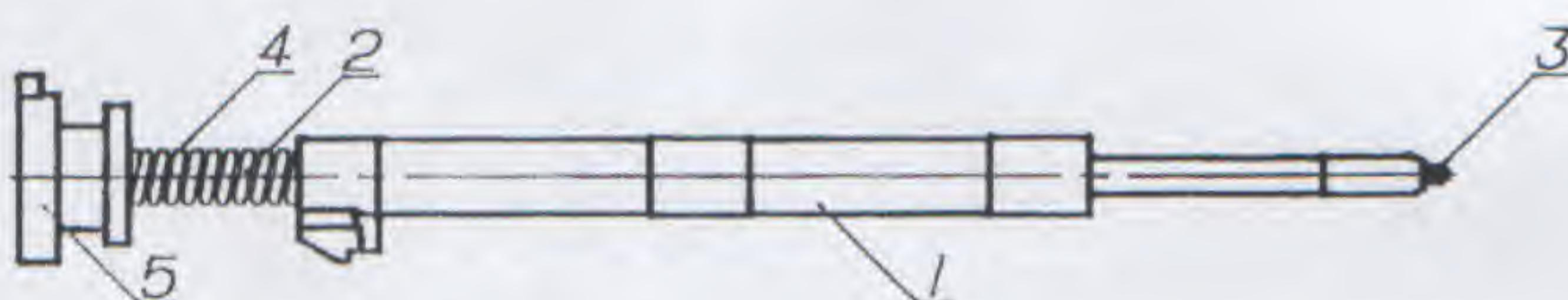
Slika 5 - Udarni mehanizam
